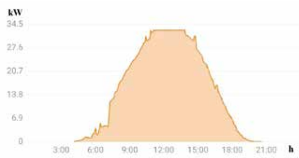
Рис. 2. Добовий профіль генерації у ясний день з характерною «полицею» на рівні AC-ліміту
