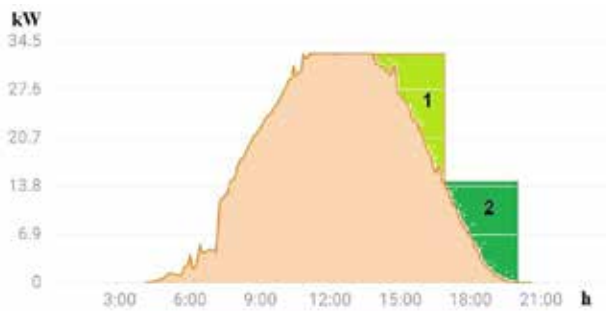
Рис. 3. Потенціал використання накопичувача енергії для зсуву генерації в часі: зона 1 – високопотужний інтервал, зона 2 – вечірній інтервал підтримки / компенсації
